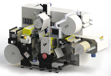
web widths: 380 mm max. unwind dia.: 650 mm max. rewind dia.: 600 mm
